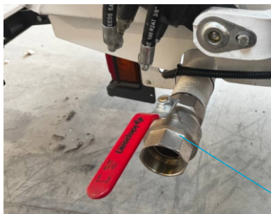
Рис. 27 Краны 1 и 2 слива фильтрата из загрузочной ванны и мусоросборника соответственно
