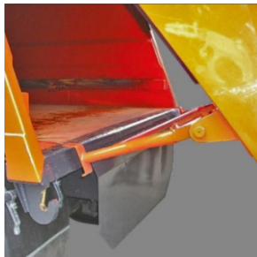
Рисунок 1. Установка страховочных штанг-подборок
